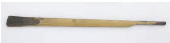
罫引(ケビキ) ：ある辺を基準にして、そこに対して平行な線を引くための道具。写真の罫引は4本の刃が等間隔に付いている。
