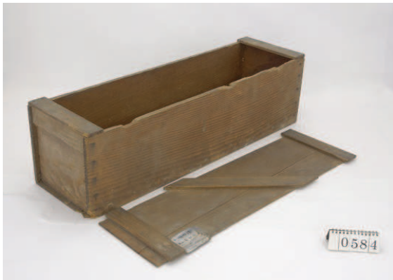
道具箱 ：大工道具を収納する箱。 高さ25cm×長88cm×幅25cm。
