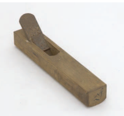
外丸鉋(ソトマルカンナ) ：台の下端が外側に湾曲した鉋、凹型の曲面を削るのに使用する。
