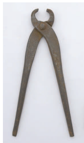
釘抜き ：ヤットコ(※)形状の釘抜き。閻魔大王が嘘つきの舌を抜く道具ともされ、エンマとも呼ばれる。 ※鍛冶屋が焼けた鉄を挟むのに使った「焼床鋏」に由来。
