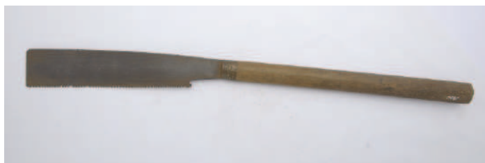
横引鋸(ヨコビキノコ) ：横引きの刃は「小刀」のように繊維を切断していくので、木目と垂直の方向や斜めの方向に切るときに使用する。
