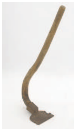
手斧(チョウナ) ：直角に曲がった大きな平鑿に木製の柄をつけた鋤形の斧。木材を平らにするのに用いる。写真の手斧は刃の脇が欠けている。
