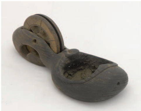
墨壺(スミツボ) ：糸車に巻き取られている糸をぴんと張って、墨汁の染みた糸の先についたピンを材木に刺す。この状態で糸をはじくと、直線を引くことができる。
