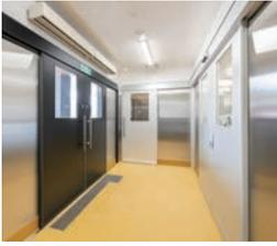
食材は搬入業者によってここへ納品された後、調理員の手で検収室へ運ばれます。虫や埃の侵入を防ぎ外気を極力取り込まないように、作業スペースとの間に扉を設置し、搬入口の上部にエアーカーテンも装備されています。
