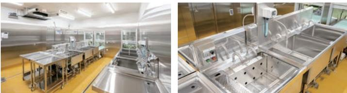
野菜を洗浄し、荒切りして野菜裁断機にかけられる状態にします。ジェット気流によるバブルリング洗浄→酸性水で殺菌→すすぎの手順で洗浄できる3槽式洗浄レーンが3レーンあり、種類による使い分けが可能です。処理済の野菜は上げ下げ窓を通して調理室へ届けます。
