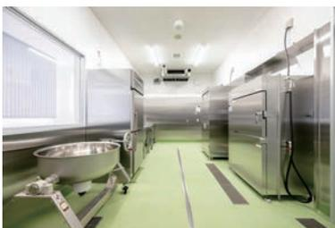
和え物やサラダ、デザートを作る部屋です。調理室との間にある両面扉の真空冷却器で急速冷却されたボイル野菜を、調合したタレやドレッシングで和えて仕上げます。また、デザートなどに使用する缶詰を開ける缶切り機も設置されています。
