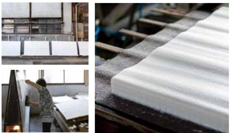
重ねた抄紙は、1ヶ月かけて天日干しにした後、再び水につけて1枚1枚丁寧に剥がし、専用の鉄板で乾燥させていく。
